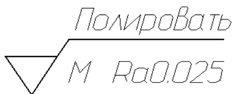
Рисунок 5. Пример указания вида обработки поверхности
